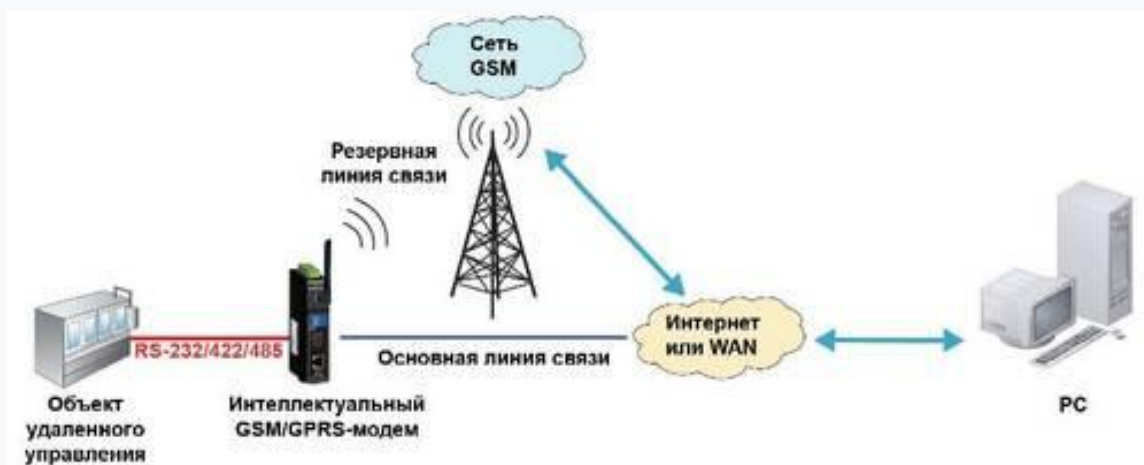
Рис.3.2. Автоматична установка резервної GSM-зв'язку при використанні "інтелектуального" модему [27]
