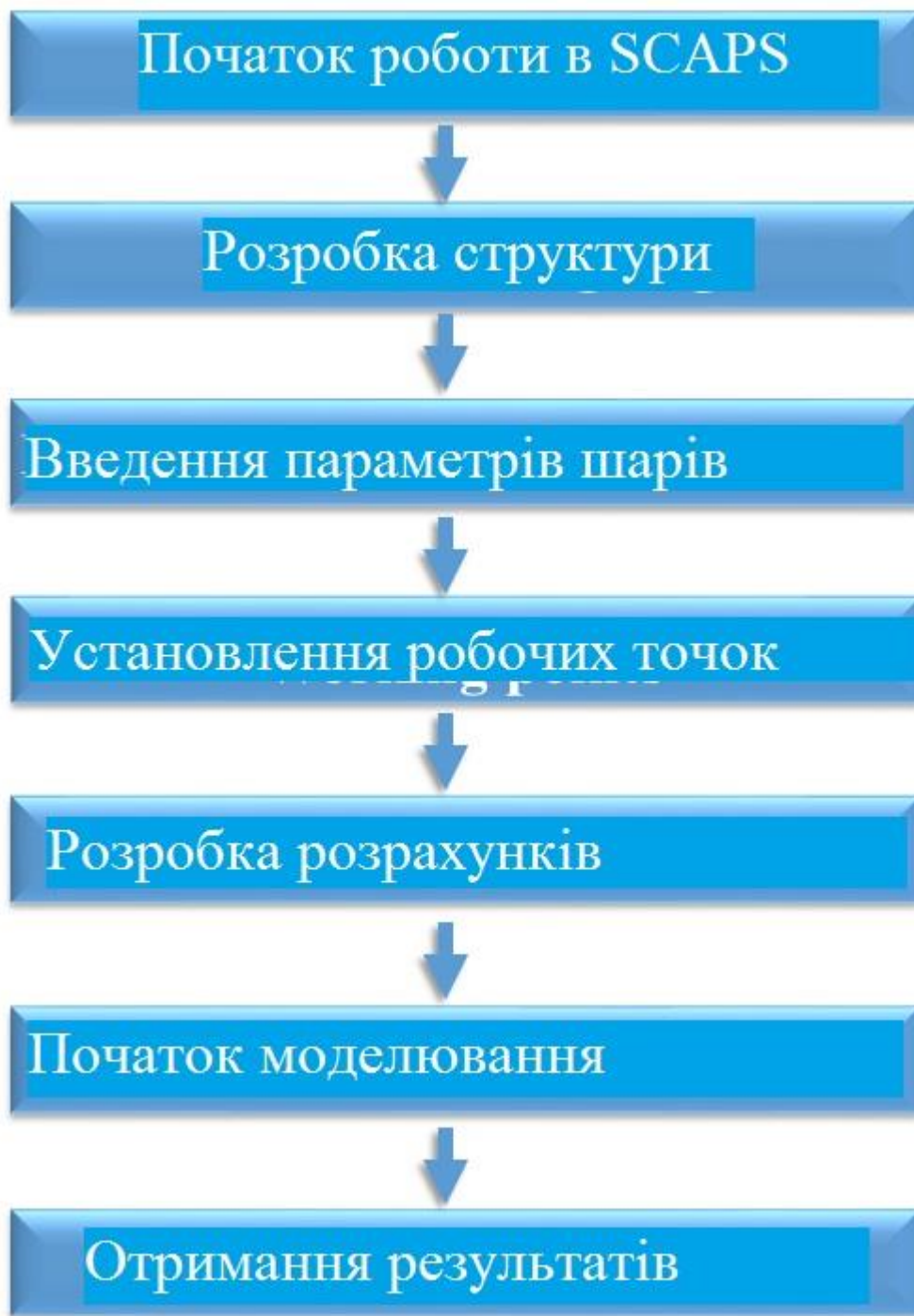
Рис. 2.1 – Алгоритм проведення числового моделювання
