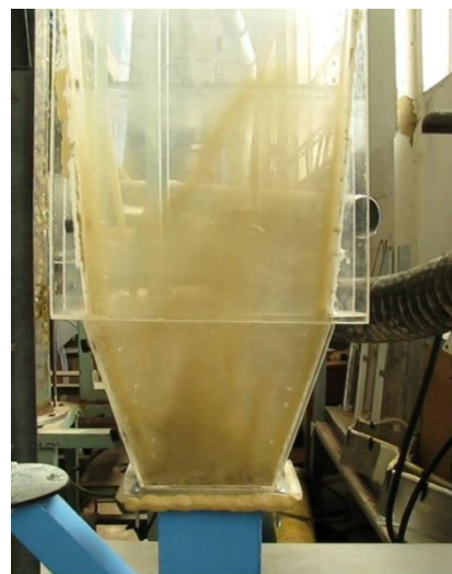
Рисунок 2.10 — Загальний вигляд зміщення центру «подушки» в процесі роботи
