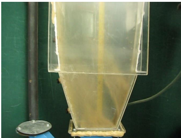
Рисунок 2.13 — Руйнування «подушки» матеріалу
