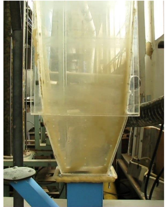
Рисунок 2.12 — Загальний вигляд розвантаженої «подушки» матеріалу
