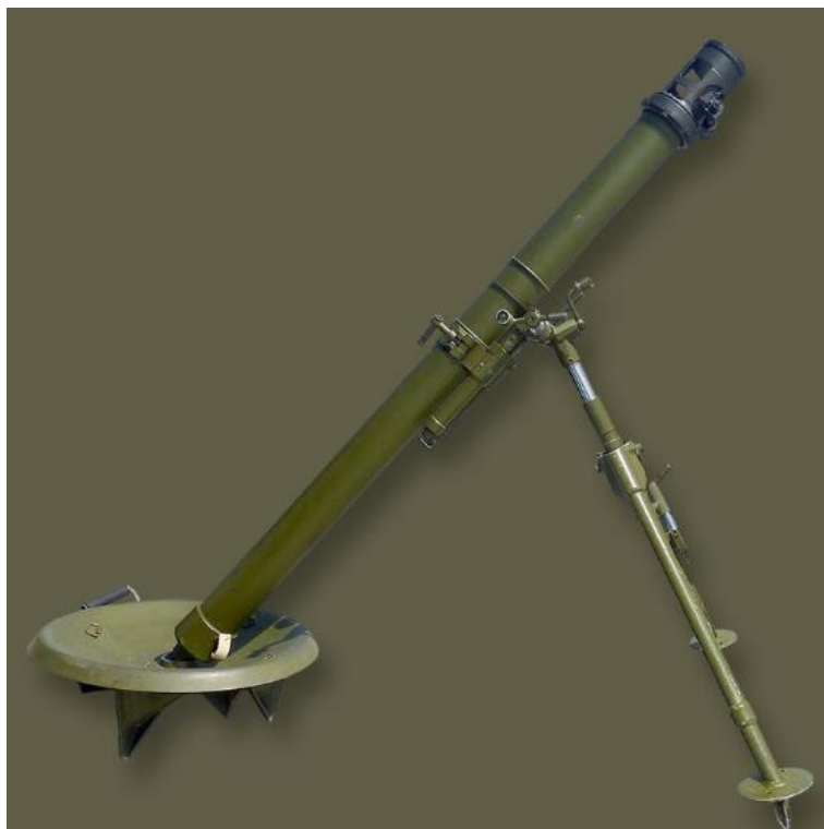
Рисунок 2.30 – 82-мм міномет 2Б14 “Поднос”:
