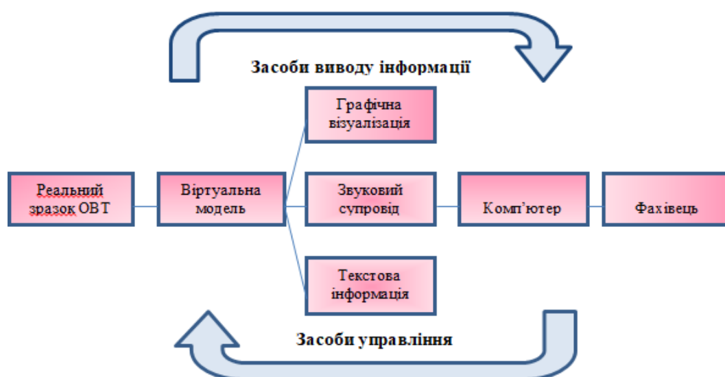
Рисунок 7.4 - Спрощена схема принципу роботи віртуального тренажера
