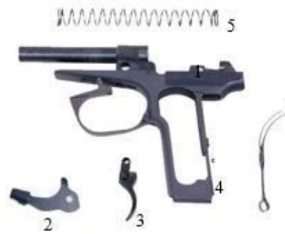
Рисунок 2.7 – Рамка зі стволом та спусковою скобою:
