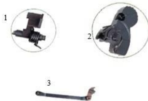
Рисунок 2.8 – Елементи ударно-спускового механізму:
