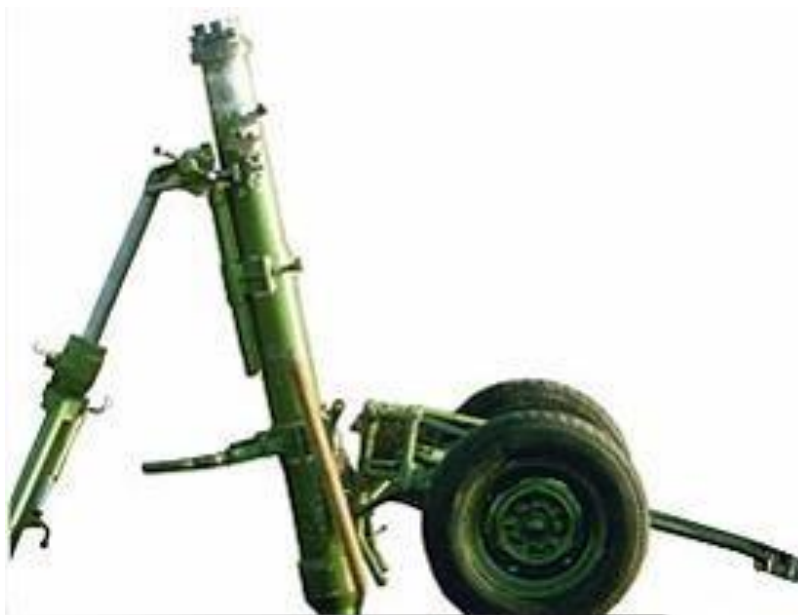
Рисунок 2.33 – 120-мм міномет М-120
