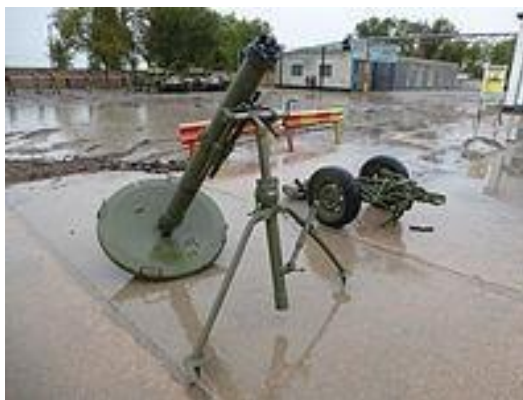
Рисунок 2.34 – 120-мм возимий міномет 2Б11 “Сани”
