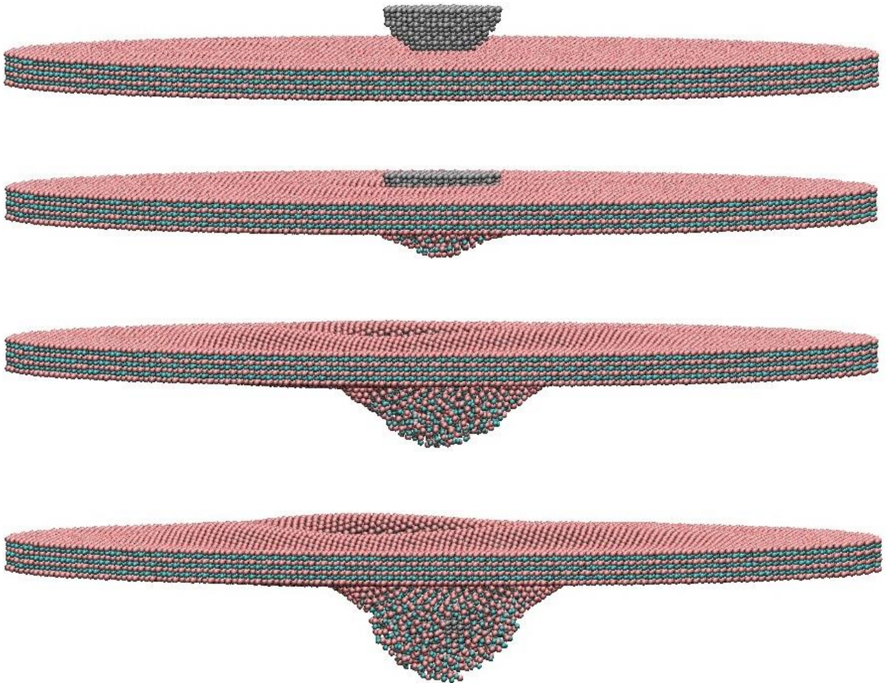
Рисунок 2.8. Атомістичні конфігурації зразка Ti_4C_3 під час інденування при параметрі взаємодії \varepsilon_0 = 0.5 еВ та швидкості інденування v_2 = 0.05 та при температурі зразка 300 К та при різних значеннях вертикальної координати центра індентера.
