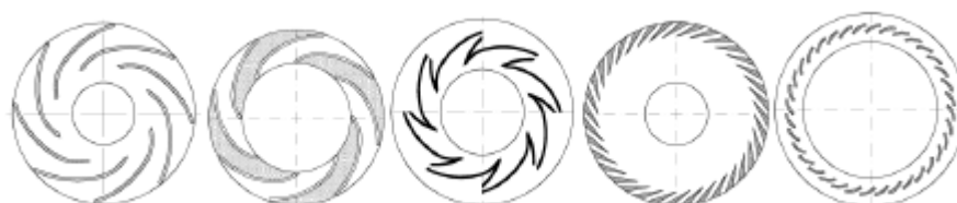
Рисунок 1.9. - Направляючий елемент з тангенційною закруткою газового потоку [176]
