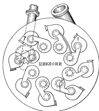
Рисунок 1.16. - Багатоциклонний спосіб закрутки потоку [179]
