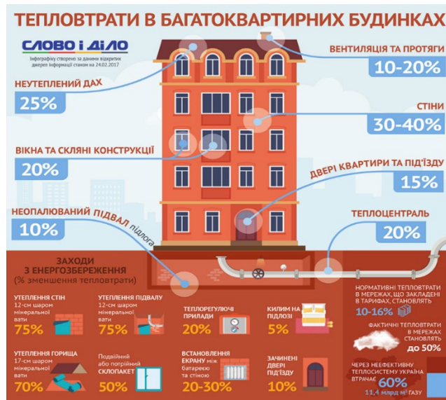
Рисунок 2.3 – Структура втрат теплової енергії будівлею [30]
