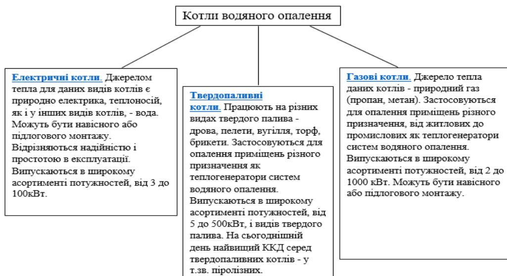
Рисунок 2.5 – Котли водяного опалення
