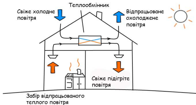
Рисунок 2.9 – Схема роботи механічної системи вентиляції з рекуперацією [36]
