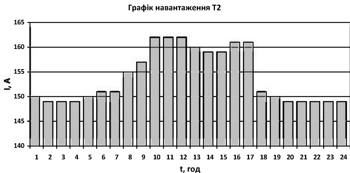
Рисунок 3.4 – Графіки навантаження на підстанції для трансформатора Т2
