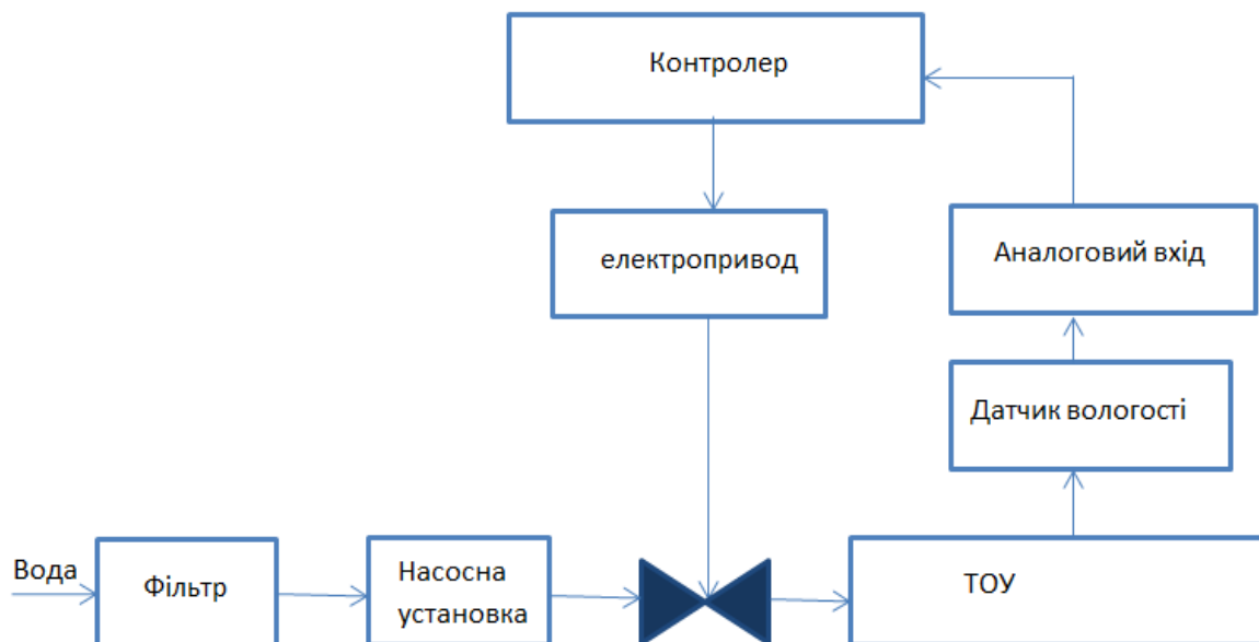
Рис.2.4. Схема регулювання вологістю через туманоутворення
