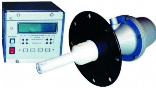
Малюнок 3.7 – концентратомір КВЧ 5М
