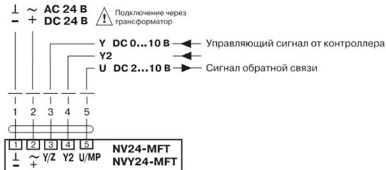
Рисунок 21 – Схема електричних з'єднань електропривода Belimo NV24-MFT
