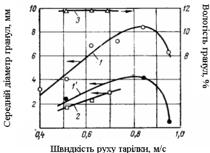
Рисунок 3 – Залежність середнього діаметру ( криві 1 та 1`), мінімального середнього діаметру ( крива 2 ) і вологості ( крива 3 ), відповідний середній діаметр від швидкості руху чаші: 1– \alpha=40^\circ ж; 1`– \alpha=47^\circ .
