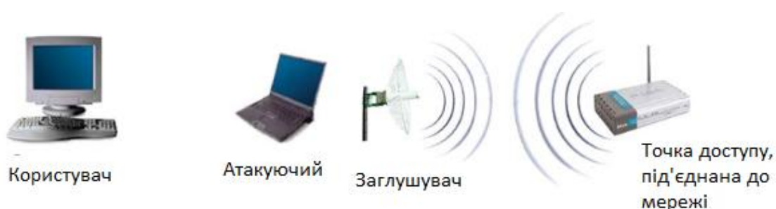
Рисунок 1.1.5 – Схема атаки «Глушіння базової станції»
