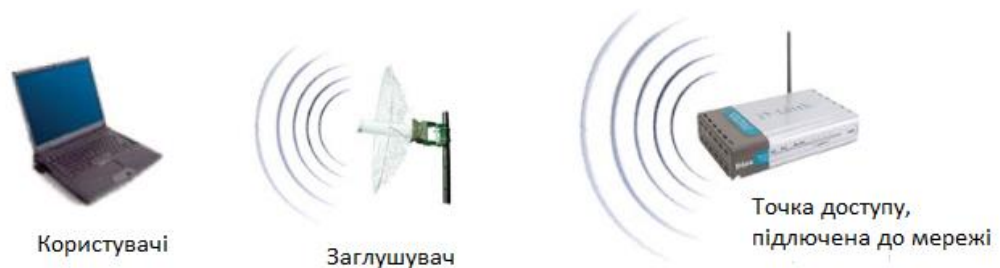
Рисунок 1.1.3 – Схема атаки «Відмова в обслуговуванні»
