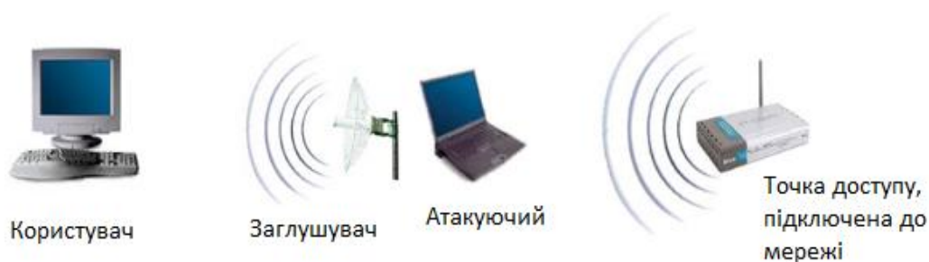
Рисунок 1.1.4 – Схема атаки «Глушіння клієнтської станції»
