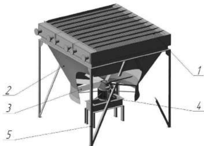
Рисунок 1.2 – Віртуальна модель апарату повітряного охолодження
