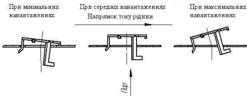
Рисунок 1.3 – Схема положення клапана при різних навантаженнях за парою
