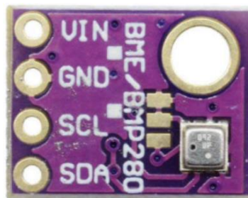
Рисунок 3.8 - Датчик вимірювання вологості, температури та тиску BME280
