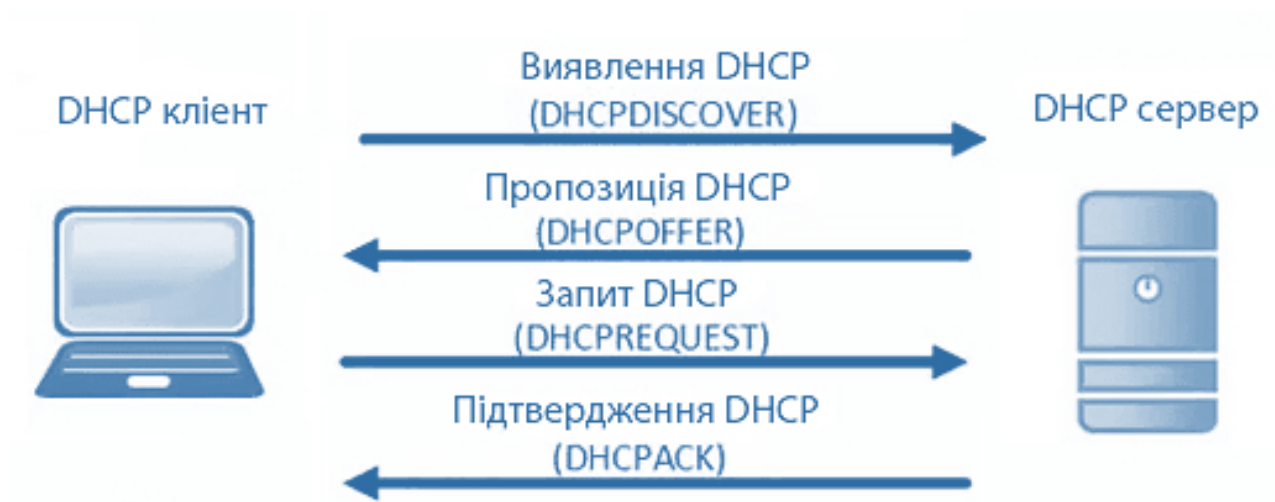
Рисунок 1.7 – Схема взаємодії по протоколу DHCP [17]
