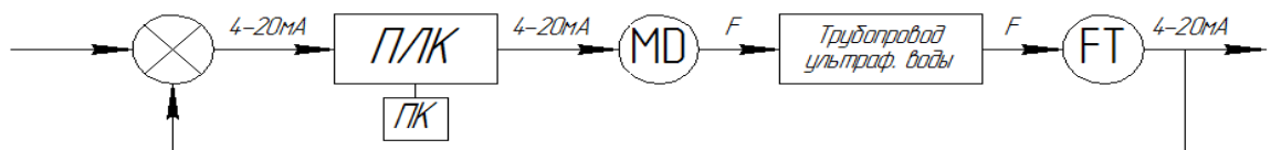
Рисунок 2.11 – Структурна схема дозування бісульфита натрію.
