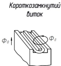
Рисунок 28 – До пояснення про короткозамкнений виток
