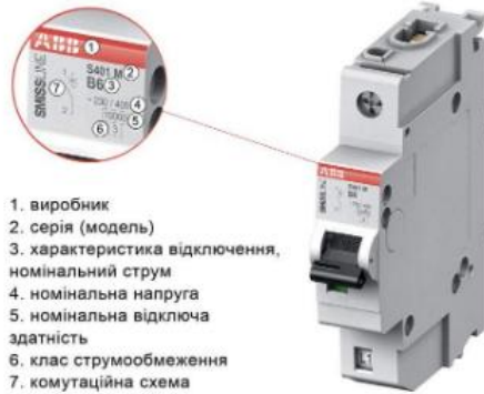
Рисунок 13 – Загальне розшифрування номінальних даних автоматичного вимикача
