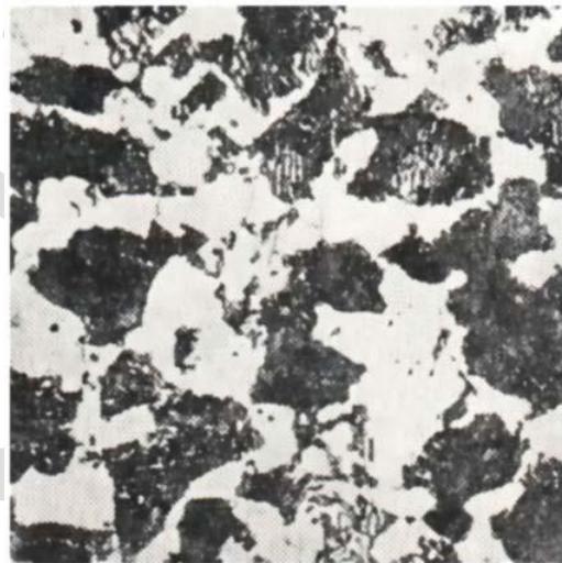
Рисунок 5.5 - Мікроструктура сталі 25ХГМ
