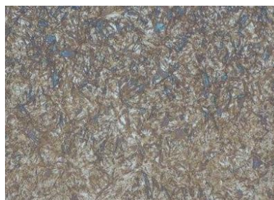
Рисунок 5.4–Структура сталі 40Х після СВЧ та низького відпуску (мартенсит відпуску), \times 500
