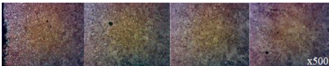
Рисунок 5.3 – Структура сталі 18ХГТ після ХТО (цементації з подальшим гартуванням з цементаційного нагрівання)
