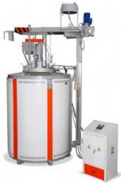
Рисунок 5.4 – Шахтна муфельна цементацийна піч СШЦМ -4.9/10,5 [32]
