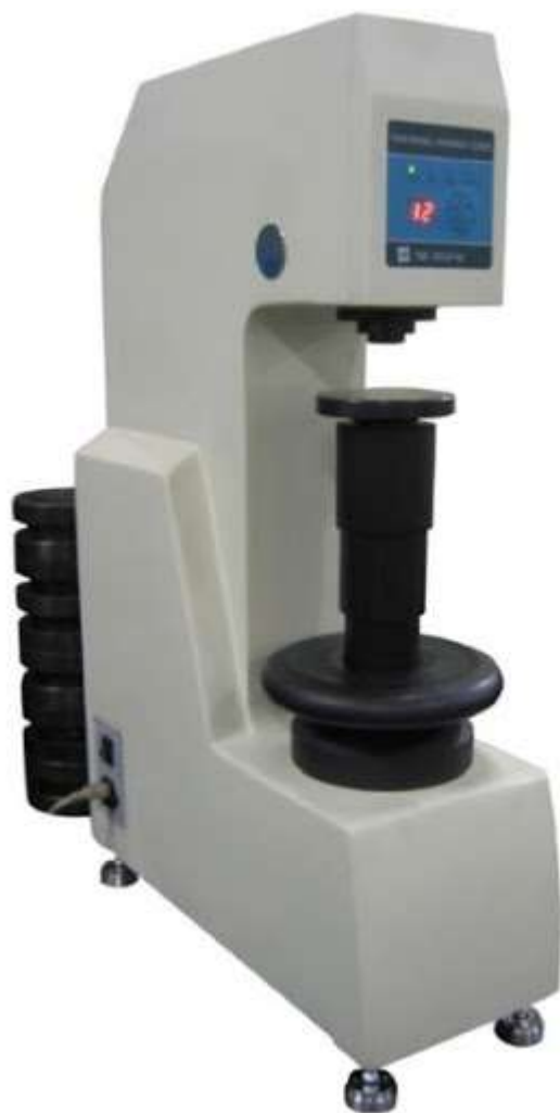
Рисунок 3.4 – Фотографія приладу ТШ-2 для визначення твердості по Брінеллю [8]
