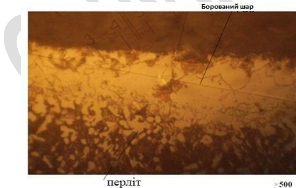
Рисунок 4.4—Фотографія структури сталі 9ХФ після борування, товщина шару 60 мкм, твердість 1200 - 1400 МПа
