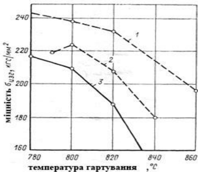
Рисунок 3.2 — Вплив V і Cr на міцність сталі з 1% Із залежно від температури загартування (відпуск 150°C); 1 - сталь з 0,5% Cr і 1% V (11ХФ); 2 - з 0,5% Cr(11Х); 3 - вуглецева сталь У11 [19]
