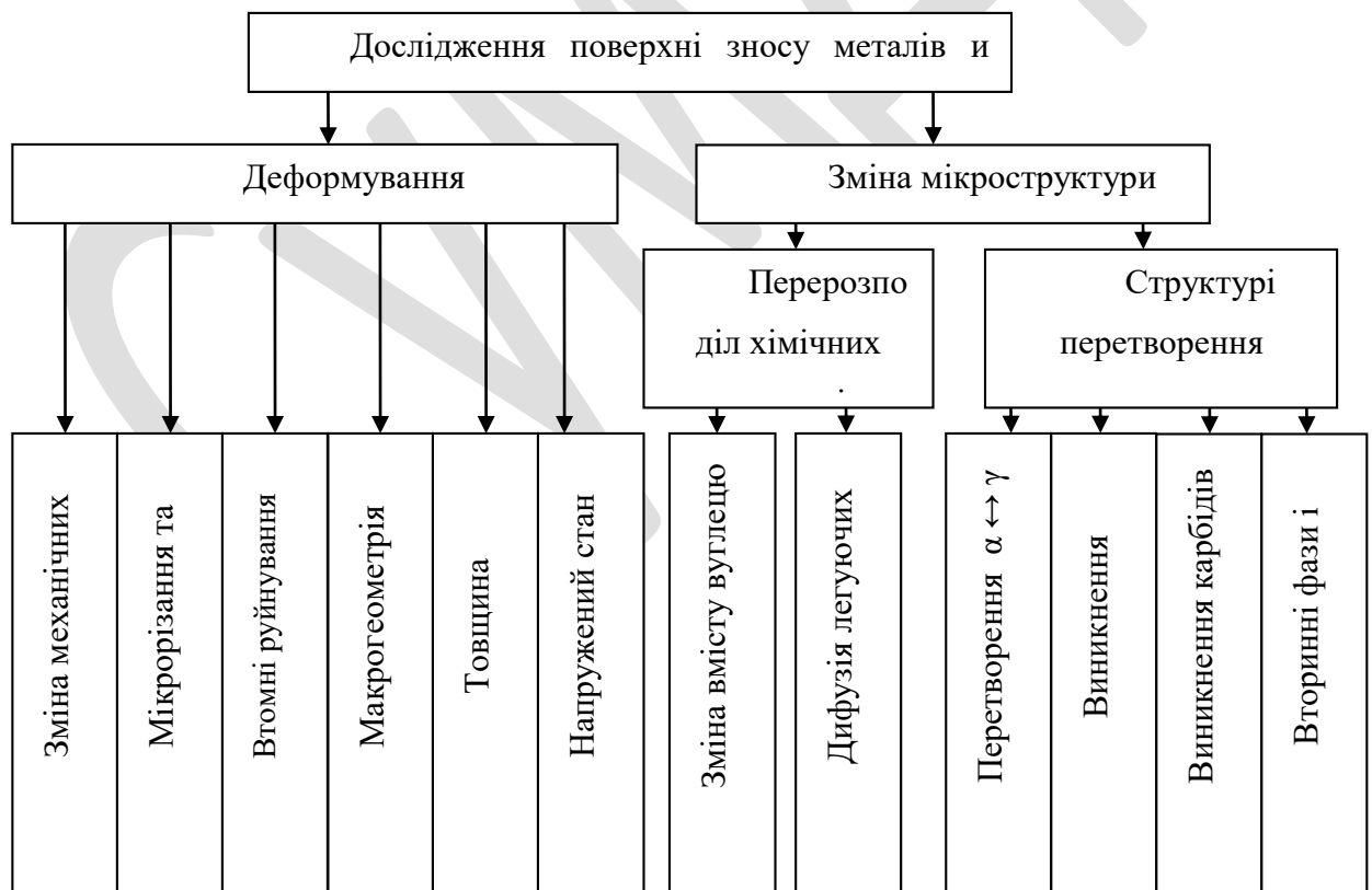
Рисунок 1.4 – Схема класифікації основних напрямків дослідження поверхонь зносу металів і сплавів
