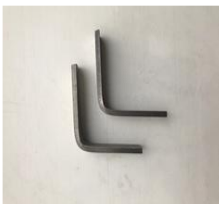
Рисунок 5.9 – Зразки сталі 14X17H2 після випробувань на МКК, метод АМУ
