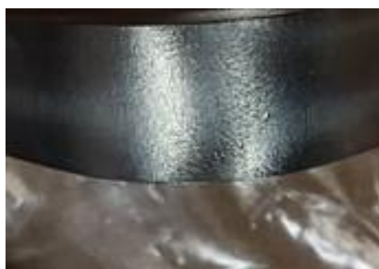
Рисунок 5.9 – Зразки сталі 14X17H2 після випробувань на МКК, метод АМУ
