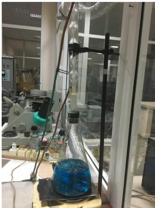
Рисунок 5.7 – Обладнання для випробування 14X17H2 на схильність до МКК
