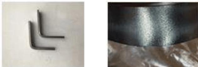
Рисунок 1 – Зразки сталі 14X17H2 після випробувань на МКК, метод АМУ
