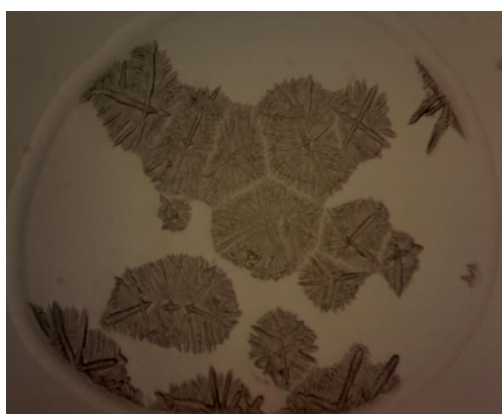
Рисунок 3.6 – Морфологічна еволюція при висиханні крапель модельного розчину на основі суміші католіту та аноліту (20 с ЕХА). Збільшення 36^x
