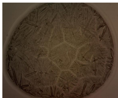
Рисунок 3.6 – Морфологічна еволюція при висиханні крапель модельного розчину на основі суміші католіту та аноліту (20 с ЕХА). Збільшення 36^x
