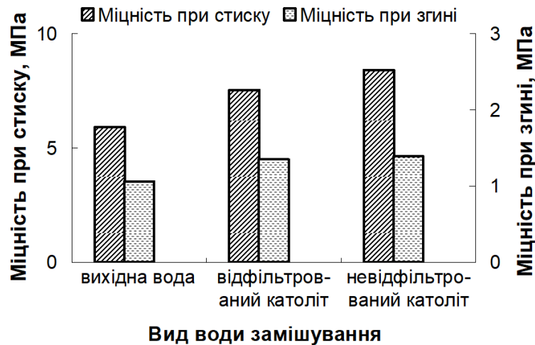
Рисунок 4.41 – Міцність гіпсового в'язучого, отриманого з використанням католіту ЕХА водопровідної води
