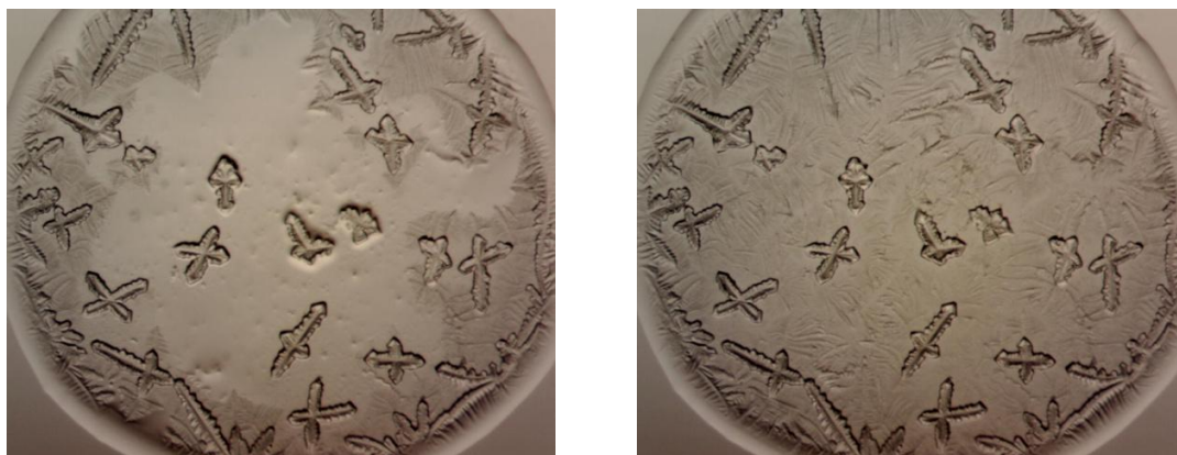
Рисунок 3.5 – Морфологічна еволюція при висиханні крапель модельного розчину на основі аноліту (20 с ЕХА). Збільшення 36^x
