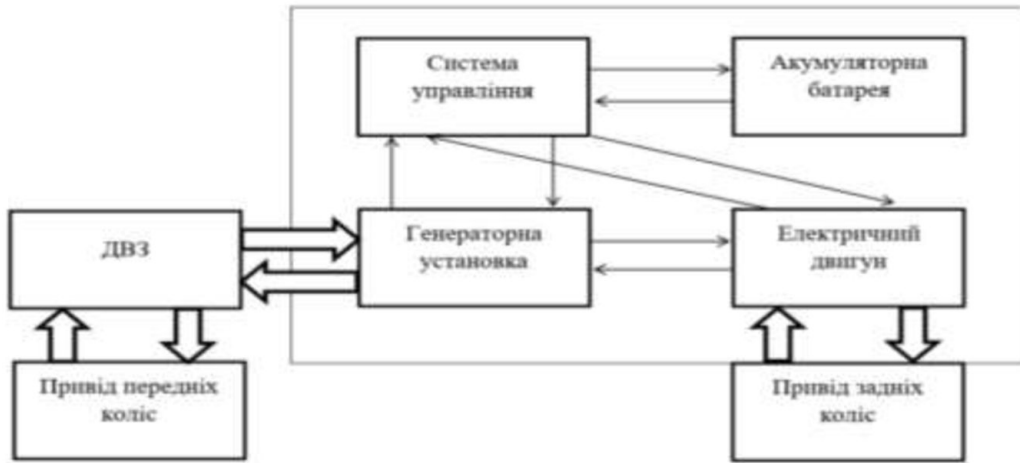
Рисунок 4.5 - Структурна схема послідовно-паралельної гібридної енергоустановки автомобіля [17]
