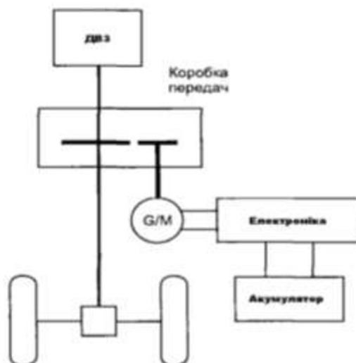
Рисунок 4.4 - Паралельна схема силової установки гібридного електромобіля [17]
