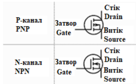
Рисунок 1.7 – Типи Mosfet транзисторів. Адаптовано з роботи [9]
