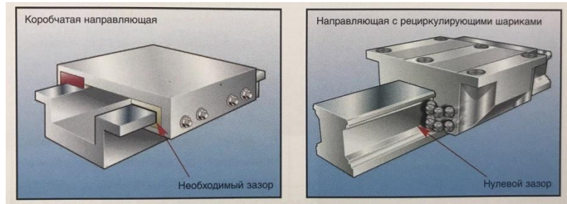
Рисунок 1.6 – Схема направляющих с рециркулирующими шариками та направляющих ковзання [13]
