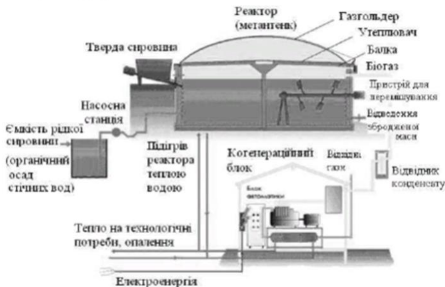
Рисунок 1.1 Принципова схема дії біогазової установки [8]
