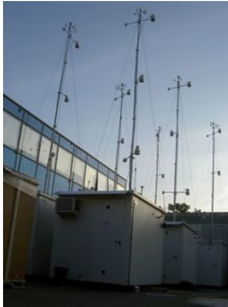
Рисунок 3.17 – Стационарний пост екологічного моніторингу атмосферного повітря [28].
