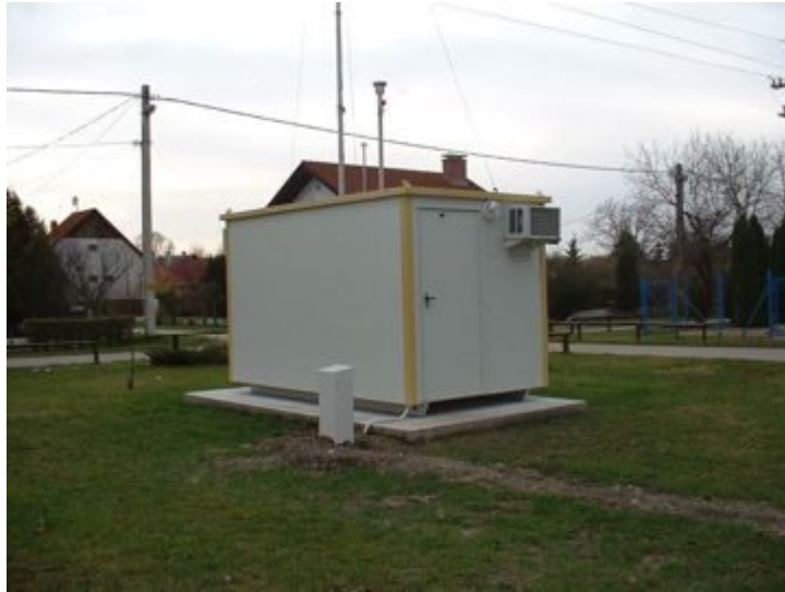
Рисунок 3.14 – Стационарний пост екологічного моніторингу атмосферного повітря [28].
