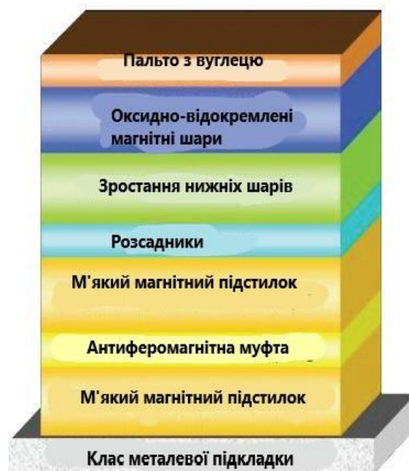
Рисунок 1.10 - Схема структури з перпендикулярною магнітною анізотропією [12]
