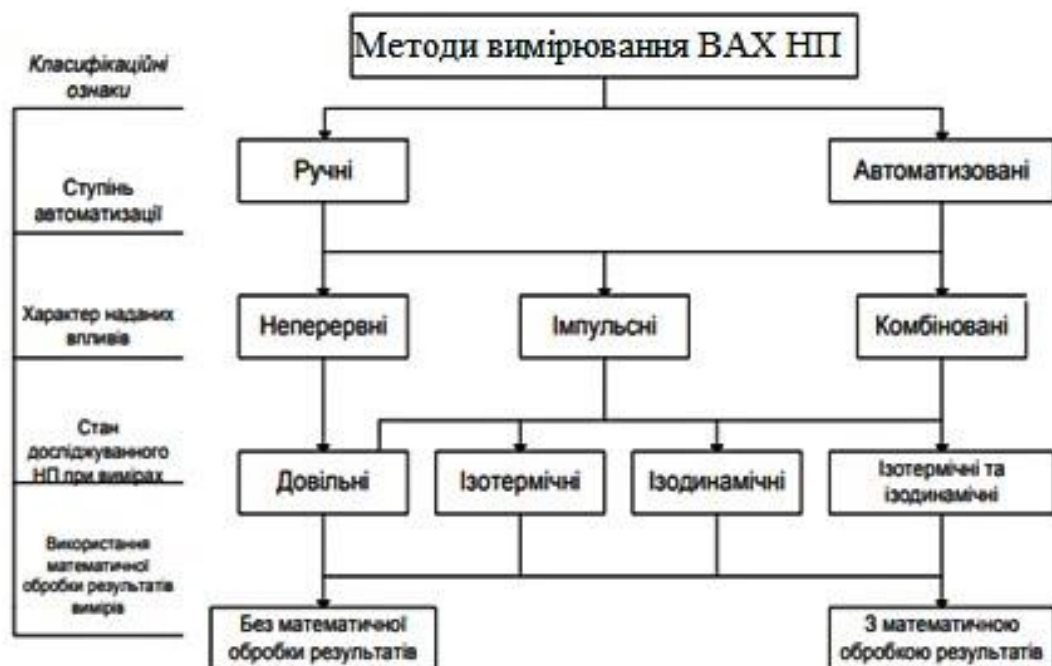
Рисунок 1.5 – Класифікацій методів вимірювання ВАХ [2]
