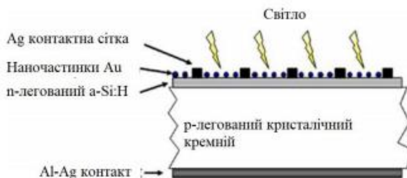
Рисунок 2.2 – Гетероструктура з осадженими наночастинками золота [3,4]
