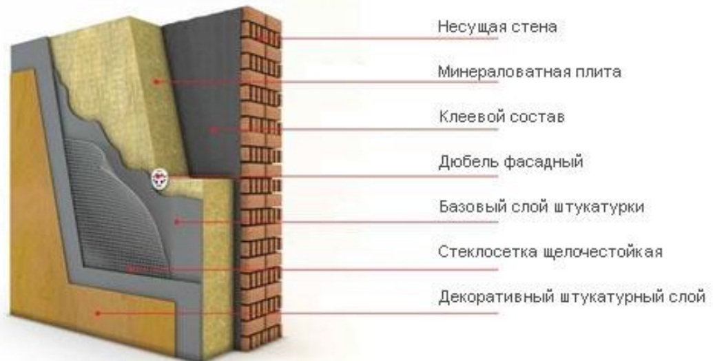
Рисунок 3.1 – Схема утеплення стіни
