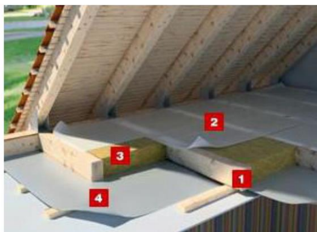
Рисунок 11 - Теплоізоляція горища: 1) Парозахисної шар; 2) Супердифузійна мембрана ; 3) Мінеральна вата; 4)Парозахисна плівка;
