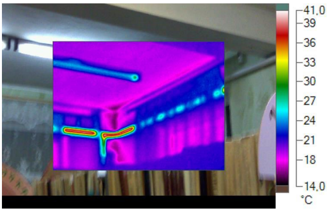
«Холодні» плями на стінах свідчить про вологу яка наявна у середині стін приміщення.
