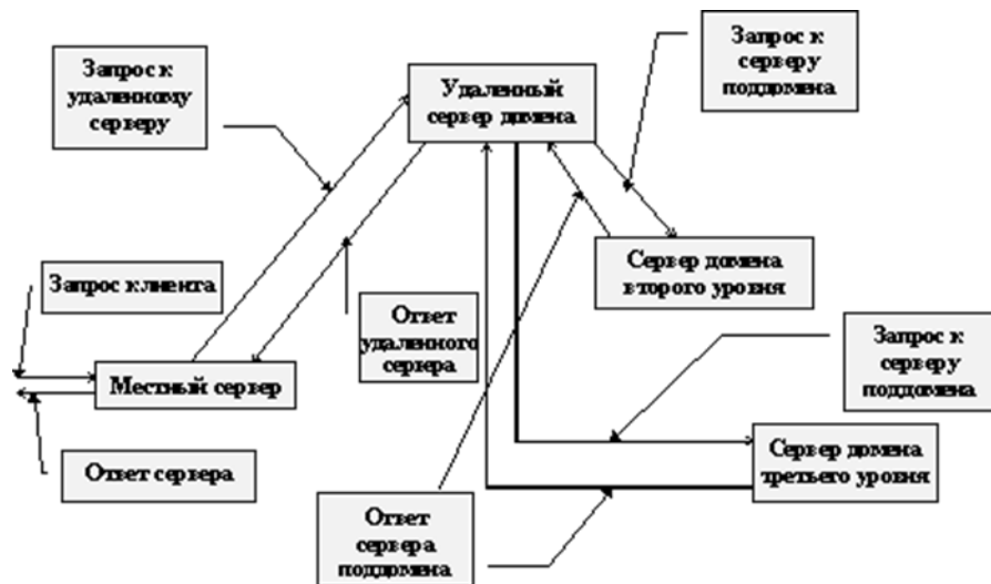
Рисунок 2.7 - Рекурсивна і нерекурсивна процедури дозволу адреси по IP
