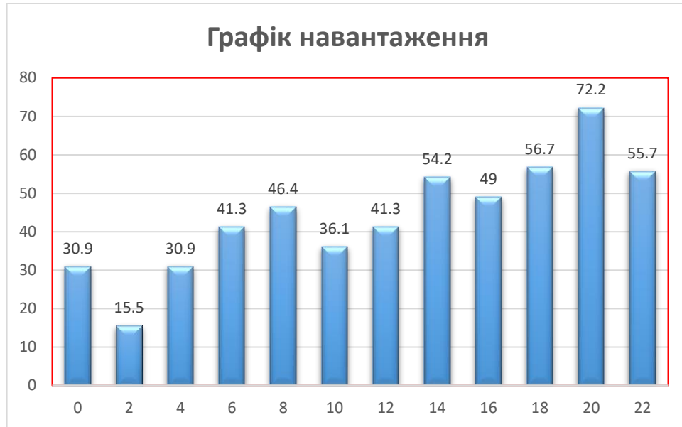
Рисунок 2.1 – графік навантаження підстанцій
