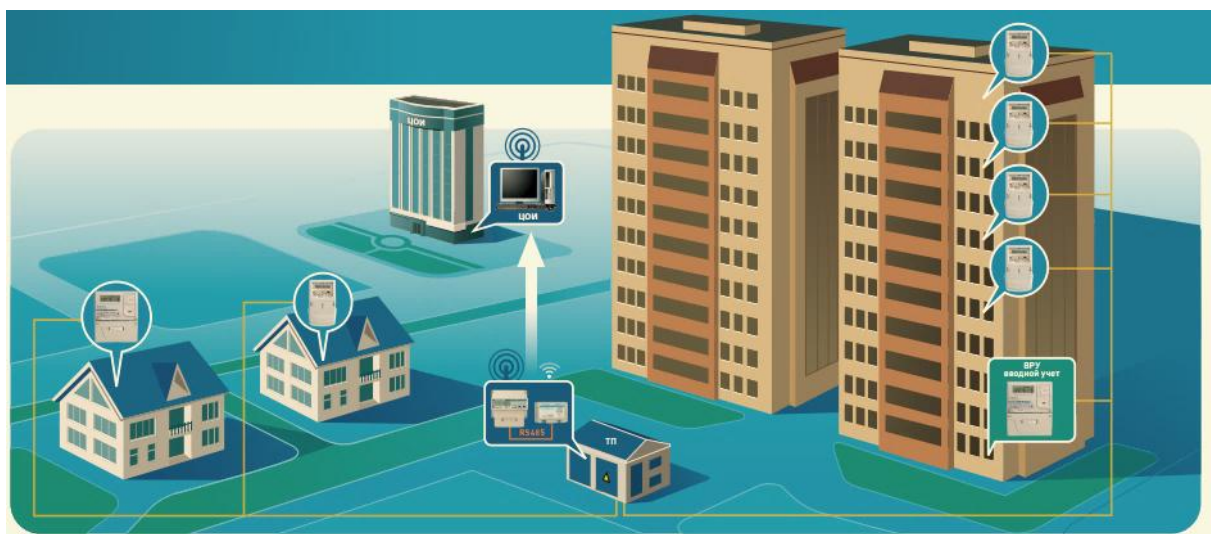
Рисунок 4- схема роботи АСКОЕ на базі PLC.
