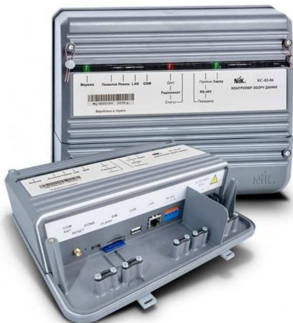
Рисунок 10. Зовнішній вигляд контролера НІК КС-02-08.
