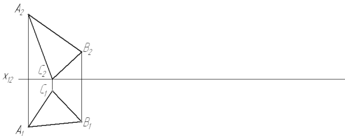
Рисунок 8.3 – Спосіб плоскопаралельного переміщення
