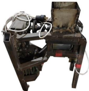
Рис. 2 - Загальний вигляд розробленої установки для подрібнення твердих полімерних матеріалів
