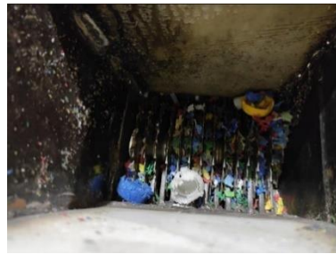
Рис. 3 – Вид зверху на дробильну камеру у процесі подрібнення пет-пляшок
