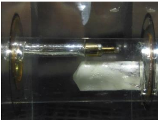
Рис. 4 – Газорідинна суміш в гідродинамічному кавітаторі з регульованим отвором
