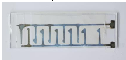
Рисунок 1 – Прототип газового детектора, отриманий методом друку з використанням чорнил Ag та ZnO
