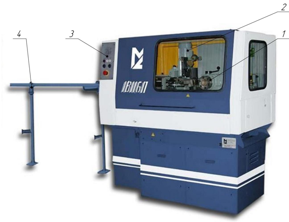
Рисунок 1.3–Токарно–револьверний прутковий верстат: 1 – револьверна головка; 2–двигун; 3 – пульт керування; 4 – бар фідер
