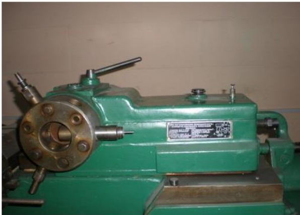
Рисунок 2.3–Револьверний супорт токарно–револьверного верстата автомата 1Б140 (а) та фірми Ergomat (б)
