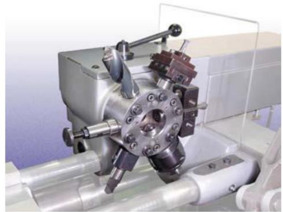
Рисунок 2.3–Револьверний супорт токарно–револьверного верстата автомата 1Б140 (а) та фірми Ergomat (б)
