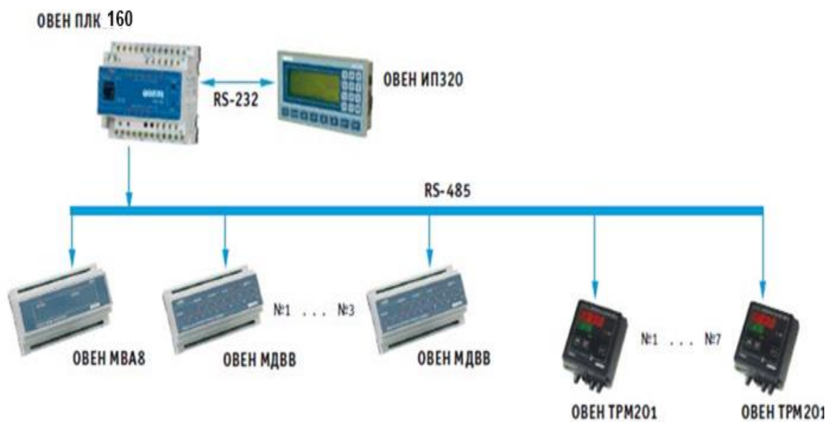
Рисунок 32 - Схема підключення периферійних пристроїв
