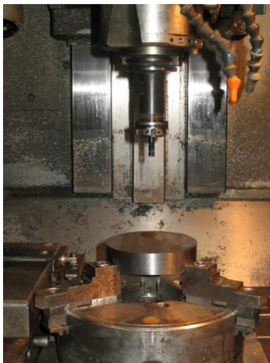
Рисунок 3.3 – Закріплення фрези та заготовки в ході експерименту
