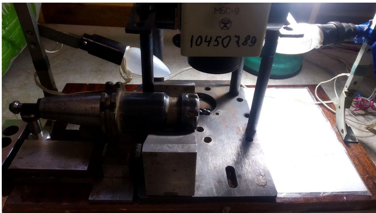
Рисунок 3.2 – Установка для вимірювання зношення інструменту
