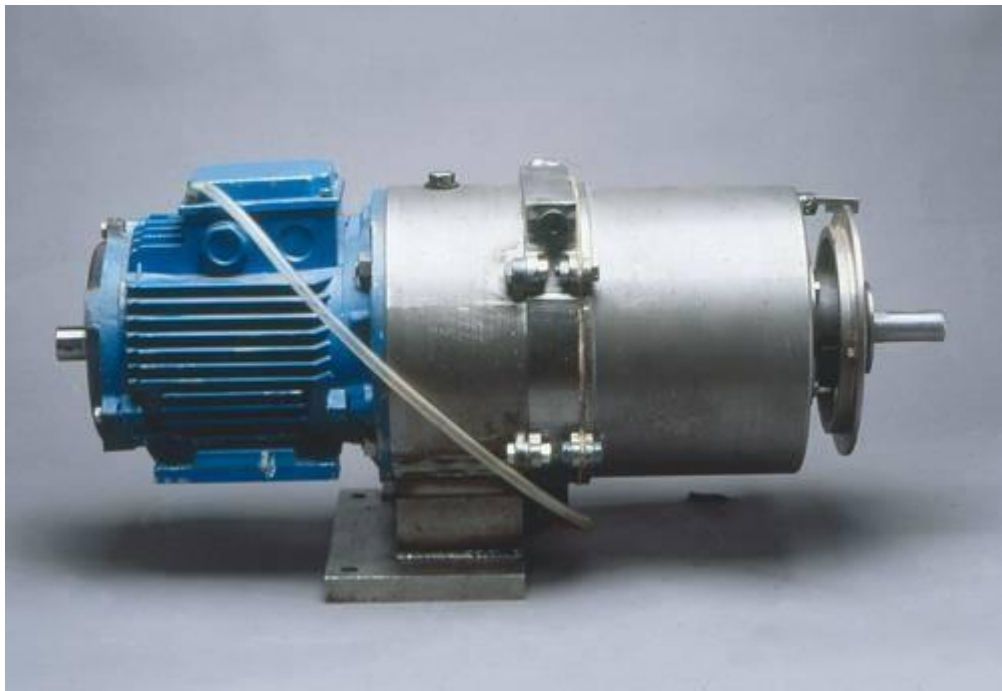
Рисунок 1.2 – Дослідний зразок суперваріатора Н. Гуліа
