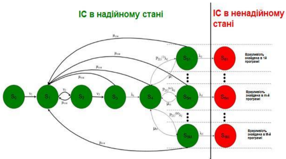
Рисунок 3.4 – Математична модель конфлікту системи з засобом захисту інформації та одного джерела негативного впливу
