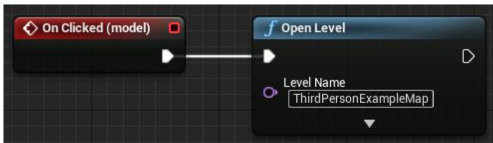
Рисунок 4.8 - Приклад Blueprint процедури для завантаження рівня
