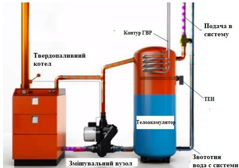
Рисунок 3.2 – Схема підключення теплоакумулятору до системи опалення
