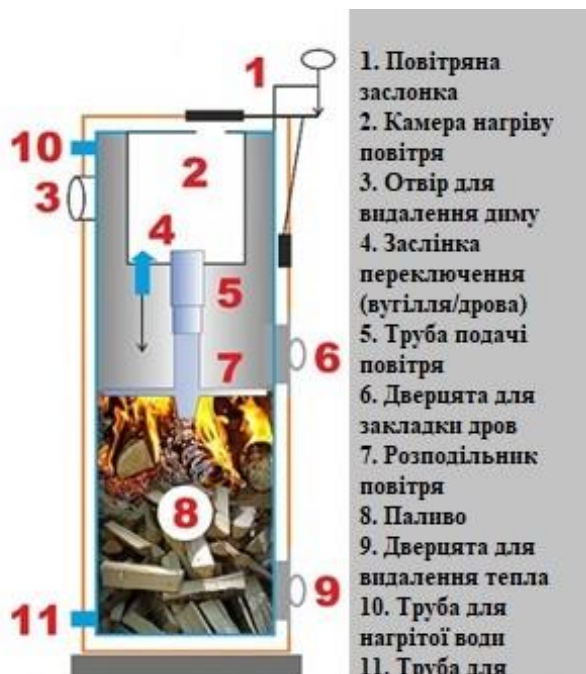
Рисунок 2.2 – Класична схема твердопаливного котлу тривалого горіння
